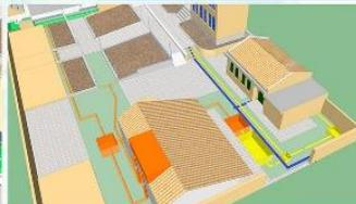
TAMBÉM AS ÁGUAS CINZAS SÃO UM IMPORTANTE RECURSO PARA A NOSSA ESCOLA. A água que provém dos lavatórios das casas de banho e da cozinha (apenas a água usada e não a água quente) é tratada através de um sistema de filtragem e depois é utilizada para regar as plantas da escola.
