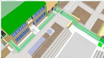
AS ÁGUAS DAS CHUVAS SÃO UM IMPORTANTE RECURSO PARA A NOSSA ESCOLA. Depois de serem captadas as águas da chuva e depois as armazenamos num grande depósito situado por baixo da placa decorativa e depois através de uma bomba solar levamos a água até um tanque situado por cima das casas de banho, que alimenta os autoclismos das sanitas.
